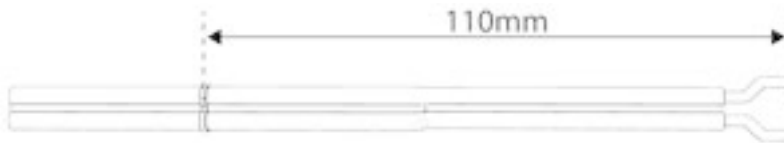
Abbildung 14: Markierung des Kabels
